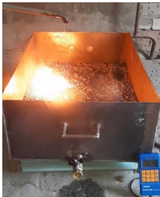
Рисунок 3.41 – Горение капельной утечки ЛВЖ в поддоне приемнике с СГП
