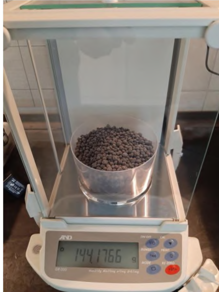
Рисунок 3.2 – Измерение массы бензина АИ-92 при испарении через СГП на аналитических весах
