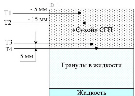
Рисунок 3.26 – Положение среды «Гранулы – СГП» относительно термодпар (окончание эксперимента)
