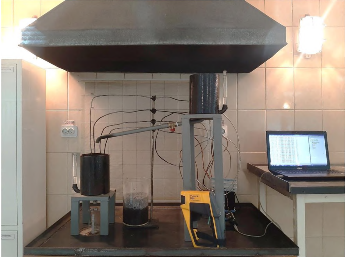
Рисунок 3.21 – Вид лабораторной установки для определения параметров гашения пламени ЛВЖ в емкости с СГП
